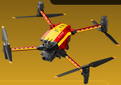
Die Matrice 30T ist eine kompakte, extrem zuverlässige Drohne. Sie ist schnell Einsatzbereit und besonders widerstandsfähig. So erreicht Sie eine sehr hohe Schutzklasse (IP 55). Das serienmäßig verbautene Kamerasystem ist hervorragend.
